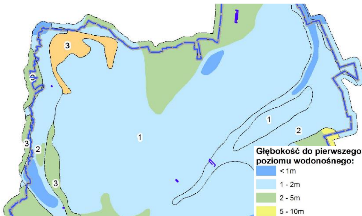
Rysunek 11. Fragment mapy głębokości pierwszego poziomu wodonośnego
