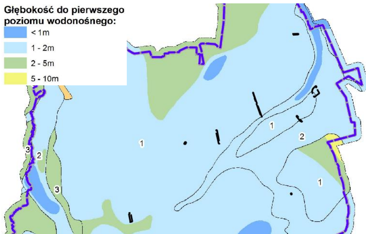
Rysunek 13. Fragment mapy głębokości pierwszego poziomu wodonośnego
